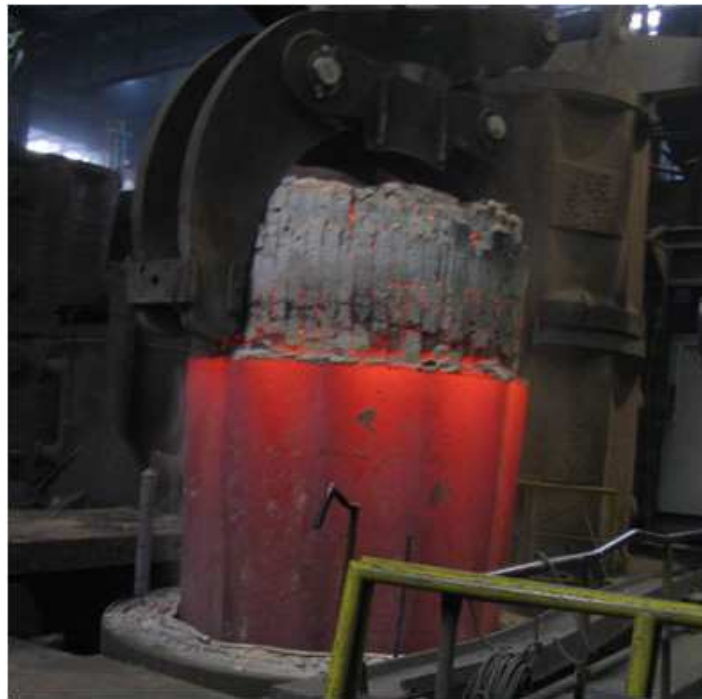
Obr. 7 Stripování ingotu (pomocí kleští) [22].
