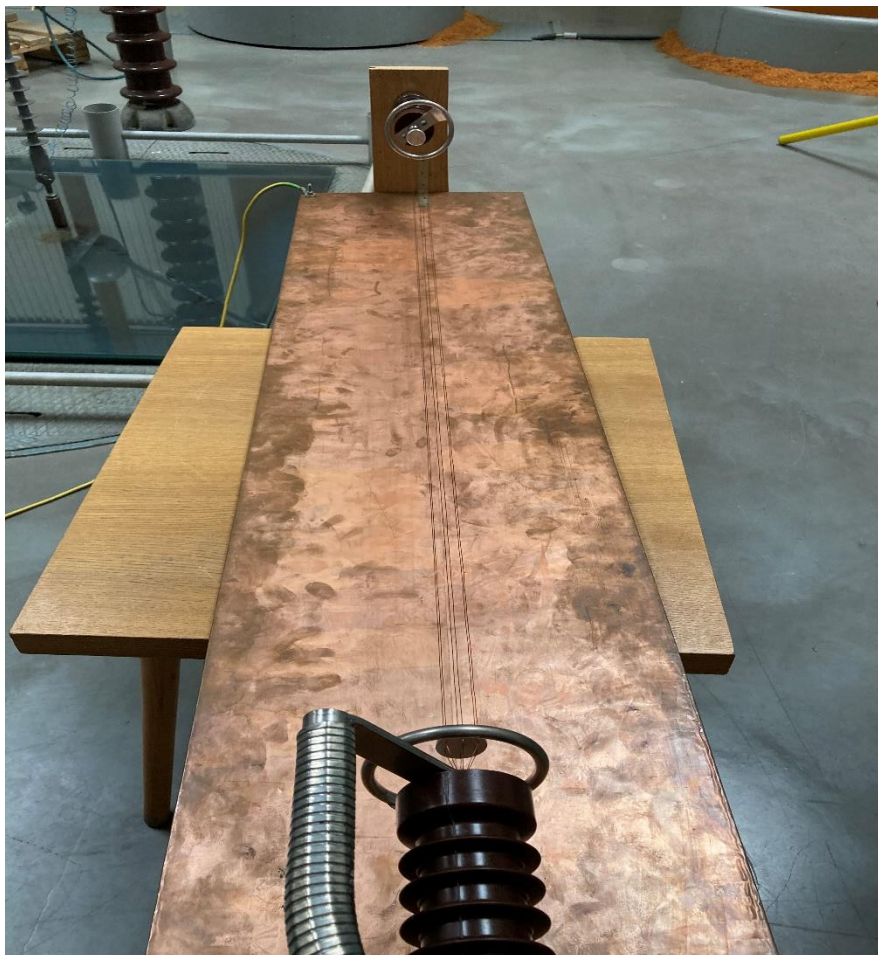
Obr. 19: Model šestisvazkového vedení o průměru vodiče 0,5 mm.
