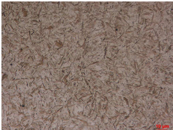
Obr. 33: E - H4 - teplota austenitizace 860°C/20min.: martenzít, světelný mikroskop
