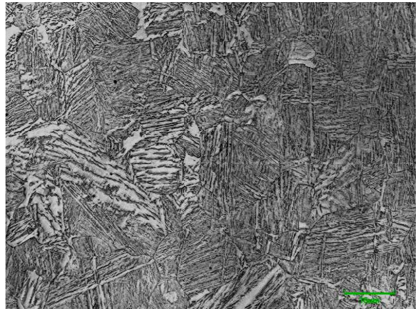
Obr. 43: A1 - H3 - 1000°C/20 min. - voda - 300°C/20 min. - voda: martenzit + bainit+ ferit, konfokální mikroskop
