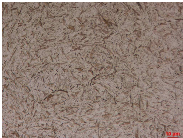
Obr. 38: I - H5 - teplota austenitizace 860°C/40min.: martenzit, světelný mikroskop
