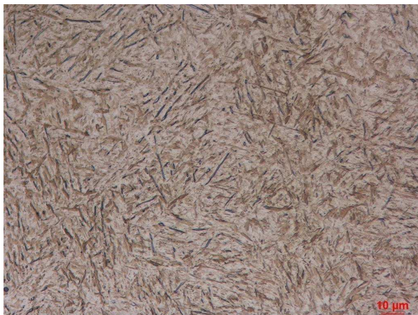
Obr. 37: CH - H5 - teplota austenitizace 860°C/20min.: martenzit + bainit, světelný mikroskop
