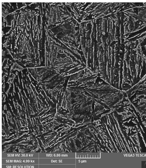
Obr. 44: A1- H3 - 1000°C/20 min. - voda - 300°C/20 min. - voda: martenzit - hranice původního austenického zrna, REM
