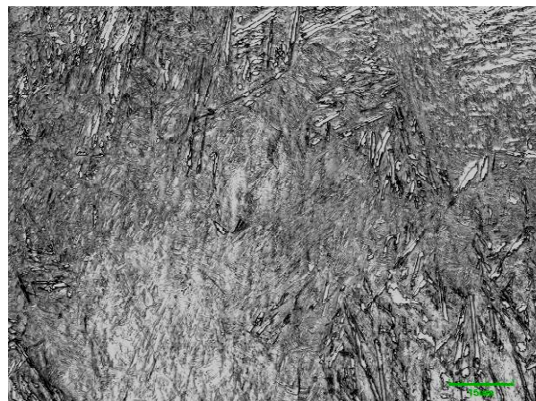
Obr. 55: H1 - H5 - 860°C/20 min. - 200°C/20 min. - voda: martenzit + bainit, konfokální mikroskop
