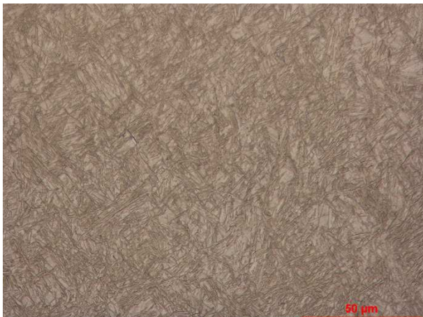
Obr. 78: DS2 - H4 - 950°C/100 s - 150°C - 200°C/10 min. - vodní mlha: martenzit, světelný mikroskop
