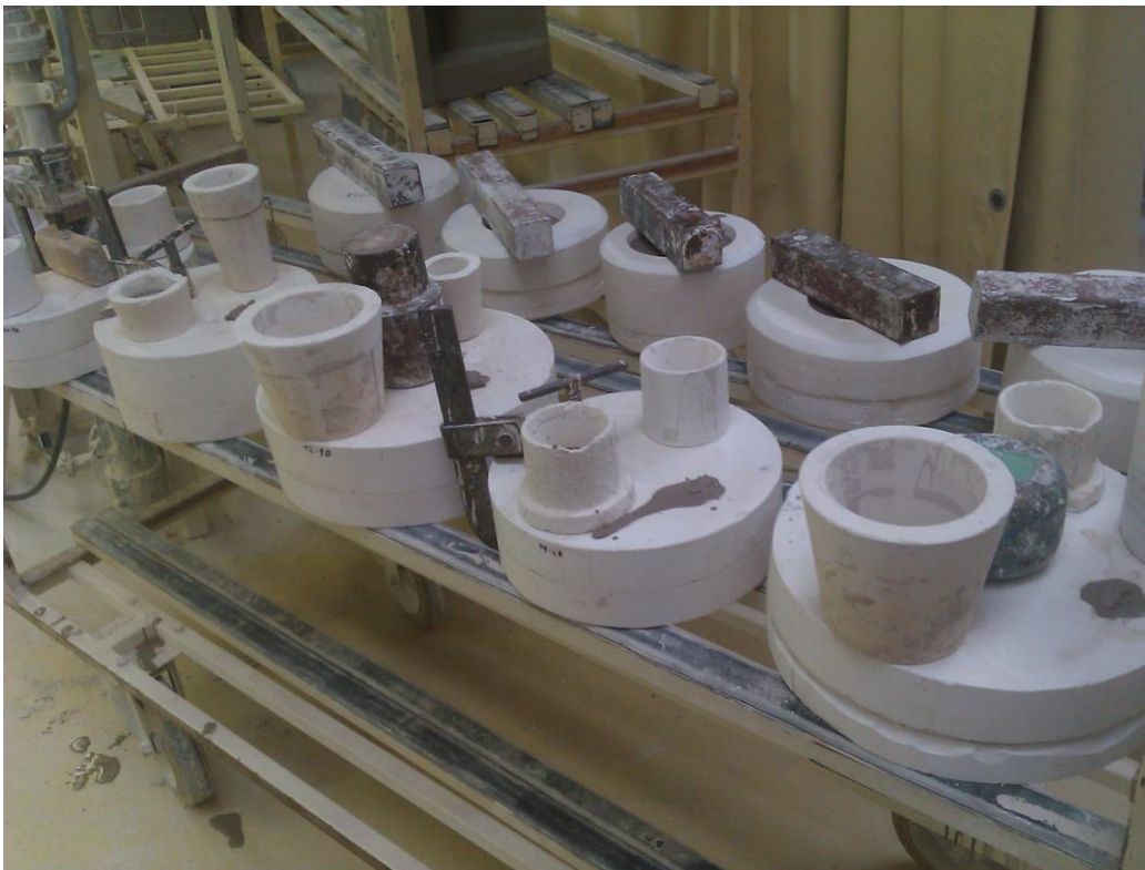
Příloha 11: Formy připravené na nalévání žáehlíny [foto vlastní]
