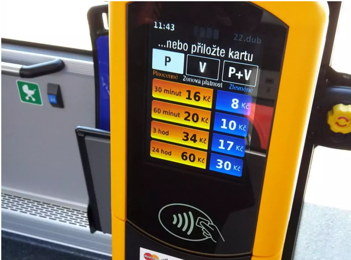
Фото №13. Автомат для бесконтактной оплаты проезда в г. Пльзень. zdopravy.cz [online] ©2020 [cit. 09.04.2020] Dostupné z: https://zdopravy.cz/jizdenka-koupena-kartou
