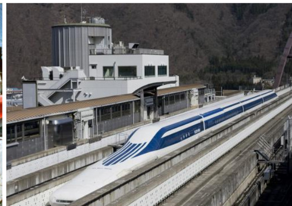
Obr. 2.9 Vozidlo využívající EDS: MLX01 – 901 (převzato z [12])
