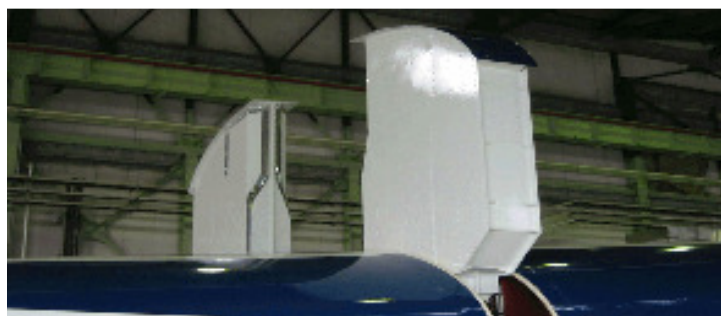
Obr. 2.15 aerodynamická brzda (převzato z [12])
