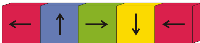
Obr. 1.2 Halbachova soustava permanentních magnetů (převzato z [3])
