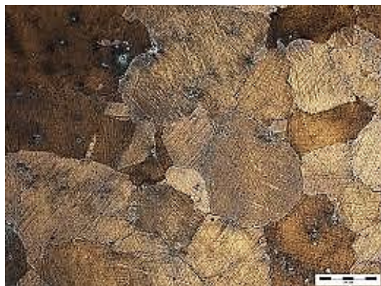
Obr. 6 Výskyt deformačních pásů uvnitř transformovaných austenitických zrn [14]
