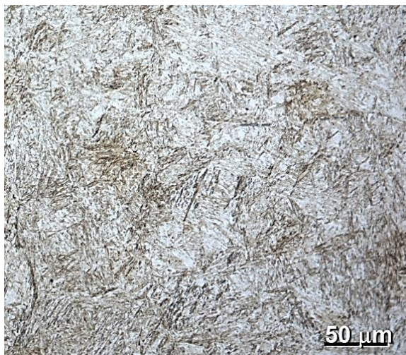
Obr. 44 AHSS-1, režim č. 4, rychlost ochlazování 0,2 °C/s, martenziticko-bainitická struktura, SM
