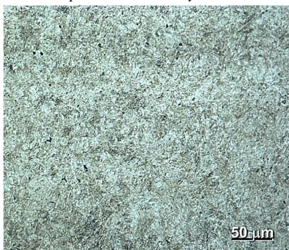
Obr. 70 AHSS-2, režim č. 3, teplota přerozdělení 300 °C, popuštěná směsná martenziticko-bainitická struktura s vyšším podílem M-A složky, SM
