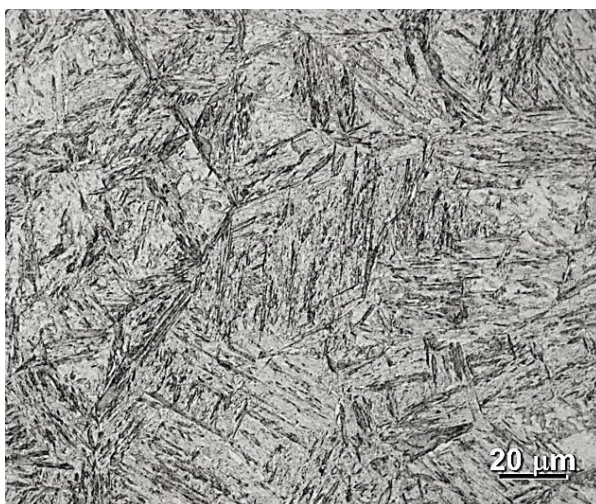
Obr. 96 Režim č. 2, rychlost ochlazování 5,7 °C/s, -196 °C, martenzitická struktura s podílem bainitu a austenitu, SM
