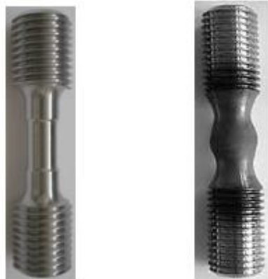
Obr. 19 Zkušební vzorek navržený pro TMZ simulátor před a po tepelném zpracování
