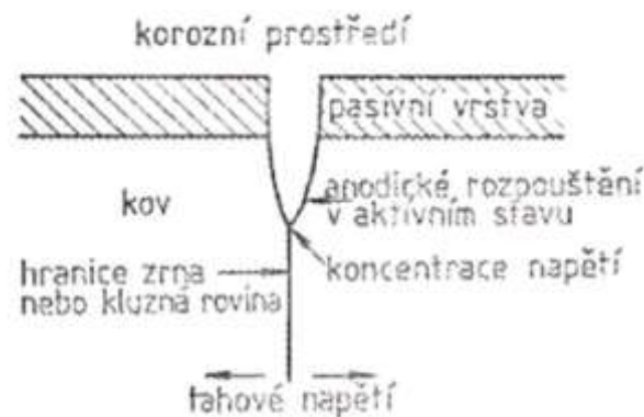
Obr. 4.10-2 Mechanismus korozního praskání [45]
