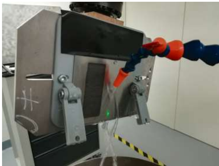
Obr. 4.4-8 Smáčení povrchu vzorku vodou při LSP procesu
