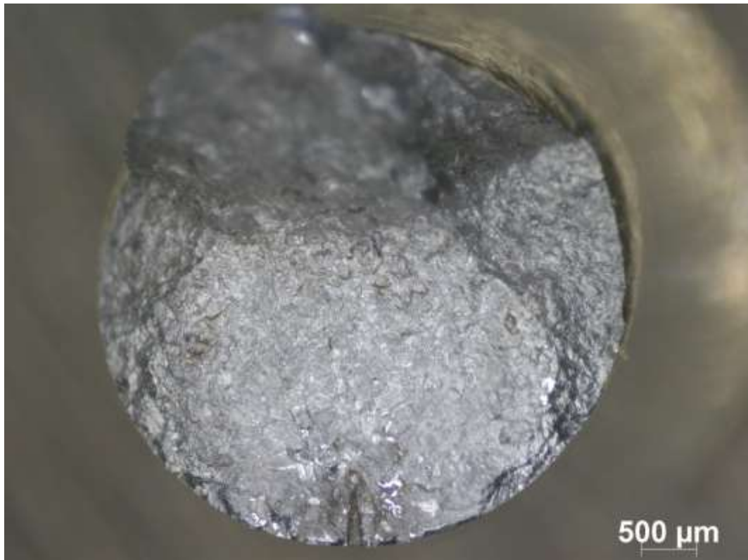
Obr. 12.12-2 Lomová plocha celého ZT v příčném směru
