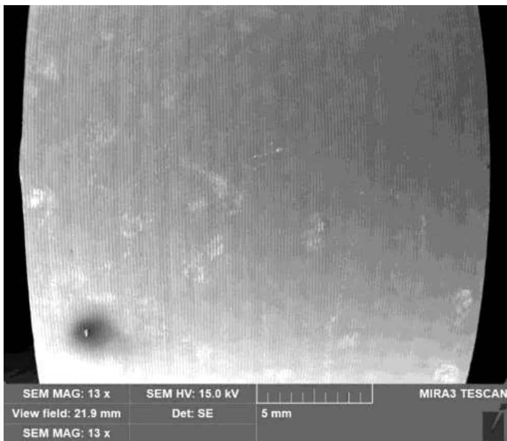
Obr. 7.6-3 Snímek povrchu vzorku po korozní zkoušce – zpevněný stav
