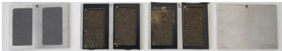
Obr. 6.2-4 Zpevněné desky pro výrobu zkušebních těles
