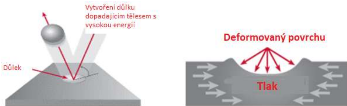
Obr. 4.1-1 Mechanismus metody SP [4]
