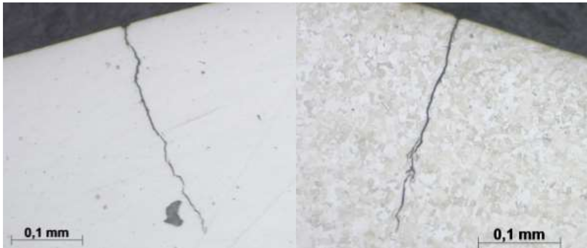
Obr. 7.6-5 Příčný výbrus vzorků (nezpevněný stav) – leštěný (vlevo) a leptaný (vpravo)
