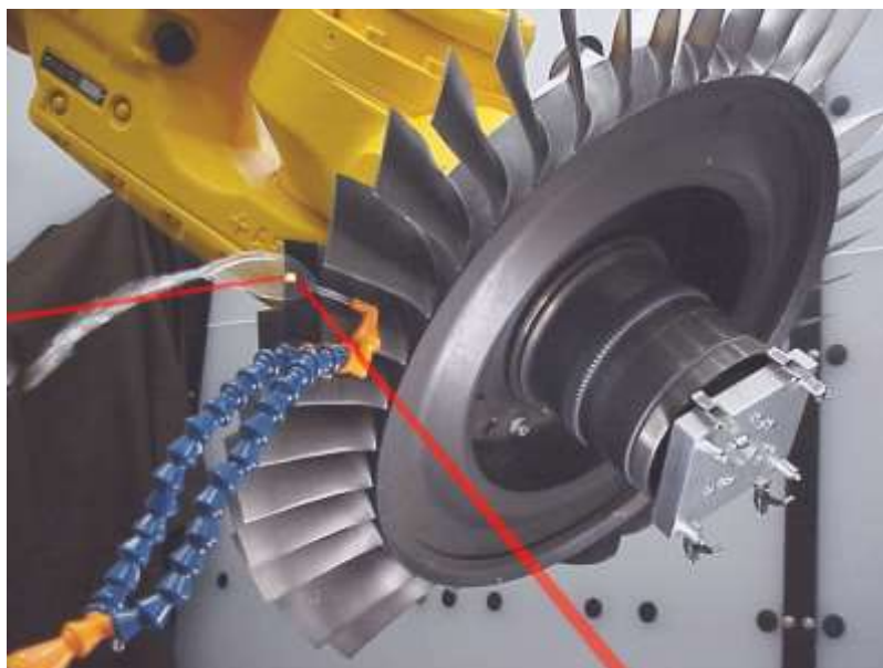
Obr. 4.4-1 Zpracování lopatek turbokompresoru technologií LSP [29]
