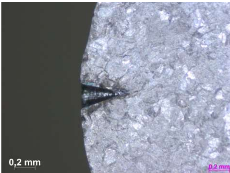
Obr. 12.6-3 Lomová plocha s vrubem
