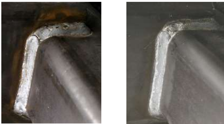
Obr. 4.2-4 Svarový spoj před [vlevo] a po [vpravo] UP modifikaci [7]
