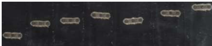
Obr. 4.4-10 Zkušební série výstřelů pro optimalizaci překryvu
