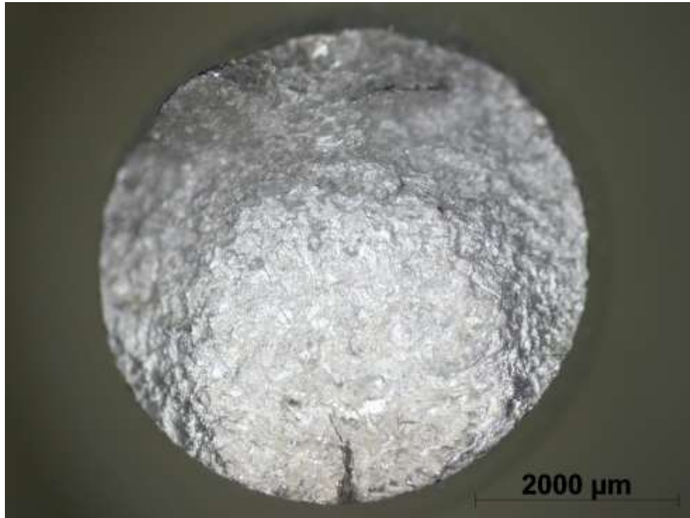
Obr. 12.8-2 Lomová plocha celého ZT v příčném směru
