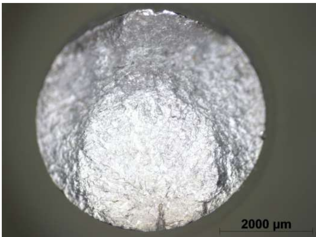
Obr. 12.7-2 Lomová plocha celého ZT v příčném směru
