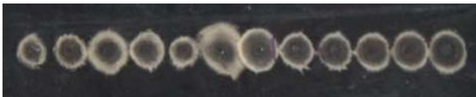
Obr. 4.4-9 Zkušební série „výstřelů“ pro hodnocení odolnosti pásky
