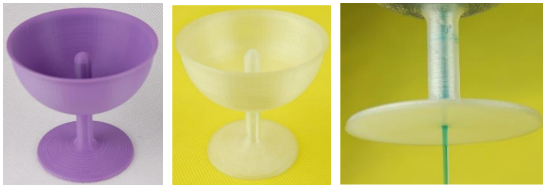
Obrázek 4: (a) Pohár vytisknutý barevným filamentem. (b) Tisk transparentním filamentem. (c) Voda vytékající z dolní části, transparentní materiál umožňující pozorovat cestu vody stopkou poháru.
