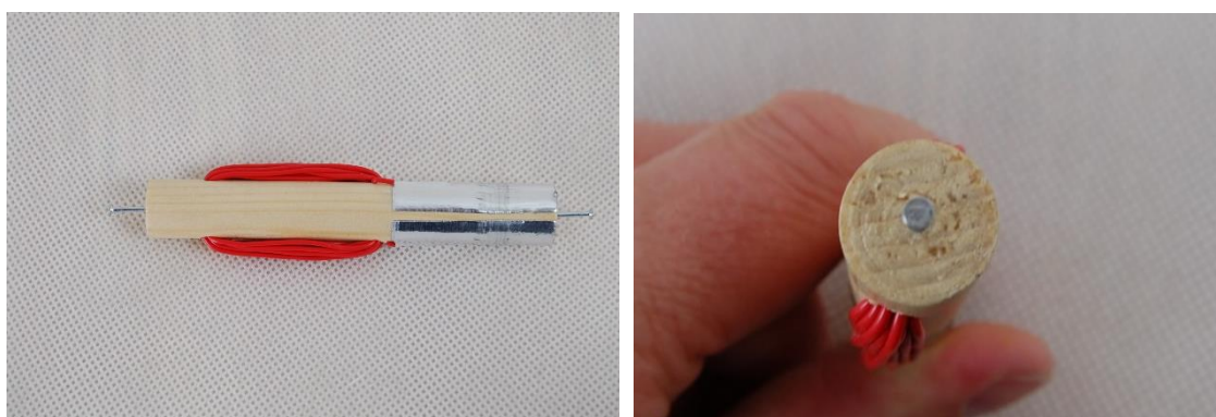
Obrázek 7: (a) Rotor stejnosměrného motoru: cívka – vodič s izolací namotaný na dřevěném válci, komutátor – dva obdélníkové kusy vodivé aluminiové fólie. (b) Detail osy rotoru – hlavičky hřebíku.
