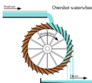
Obrázek 7: Vertikální horní kolo s horizontální osou
