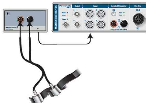
Obrázek 21: Schéma znázorňující přístroj ADInstruments PowerLab 8/30 se zesilovačem ML 116 GSR Amp a elektrodami ( www.adinstrument.com ).
