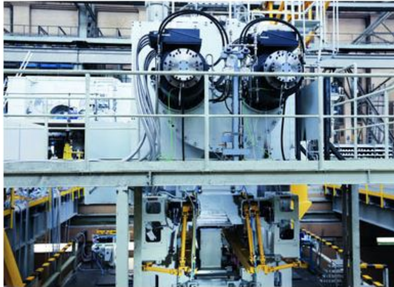
Obrázek 2.20: Klikový lis s přímým pohonem - ServoDirect Technology (Převzato z [12])
