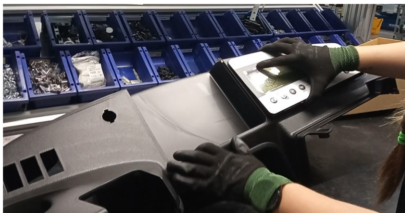
Obrázek 6-26 Umístění displeje do přístrojové desky
