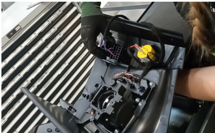
Obrázek 6-31 Zapojení konektorů do ovládacího panelu
