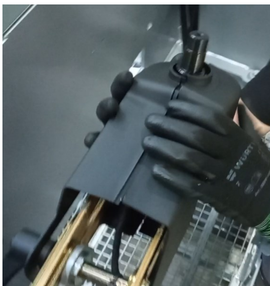
Obrázek 6-24 Montáž obložení na sloupek řízení
