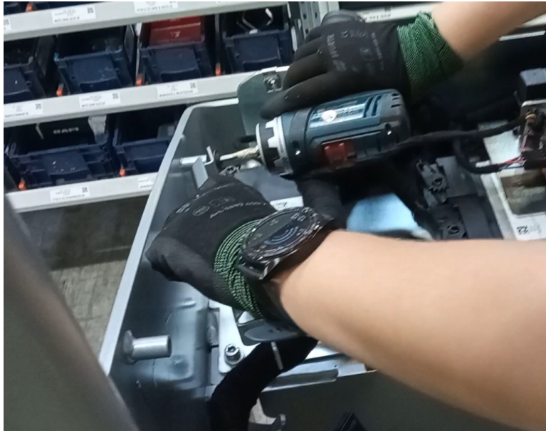
Obrázek 6-22 Montáž distančního plechu
