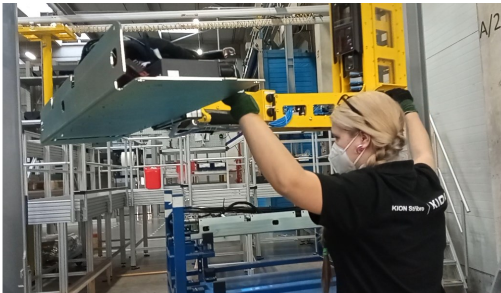
Obrázek 6-7 Přesun řadící desky do kabiny
