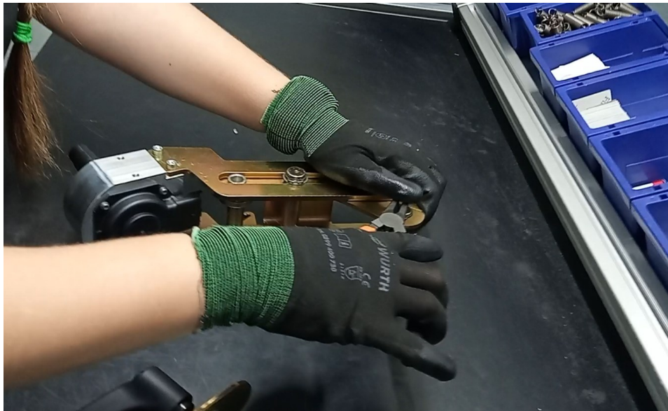
Obrázek 6-10 Vyjímání pojistného kroužku
