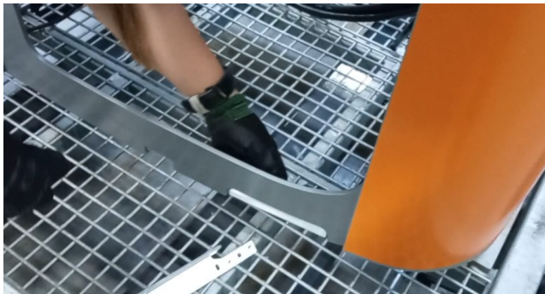
Obrázek 6-34 Montáž distančních plechů
