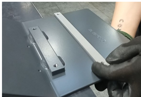
Obrázek 6-28 Svorková lišta na volitelném plechu standard
