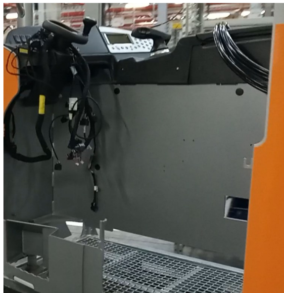
Obrázek 6-36 Upravená kabeláž v kabině
