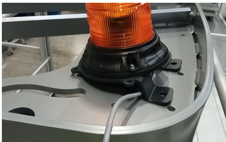
Obrázek 6-6 Kabel umístěn na kabině
