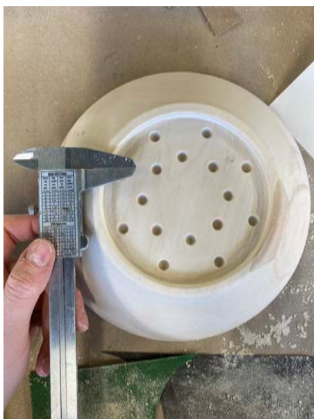
Obrázek 19 - Proces vrtání otvorů do dřevěné etue, autor Veronika Dusilová, 2022
