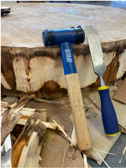
Obrázek 14 - Proces tzv. Odkůření etue/oltáře z lipového dřeva, autor Veronika Dusilová, 2022
