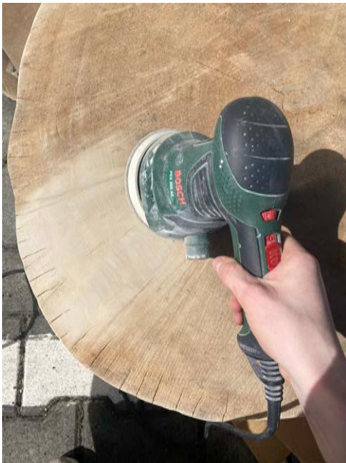
Obrázek 15 - Proces povrchové úpravy oltáře z lipového dřeva, autor Veronika Dusilová, 2022
