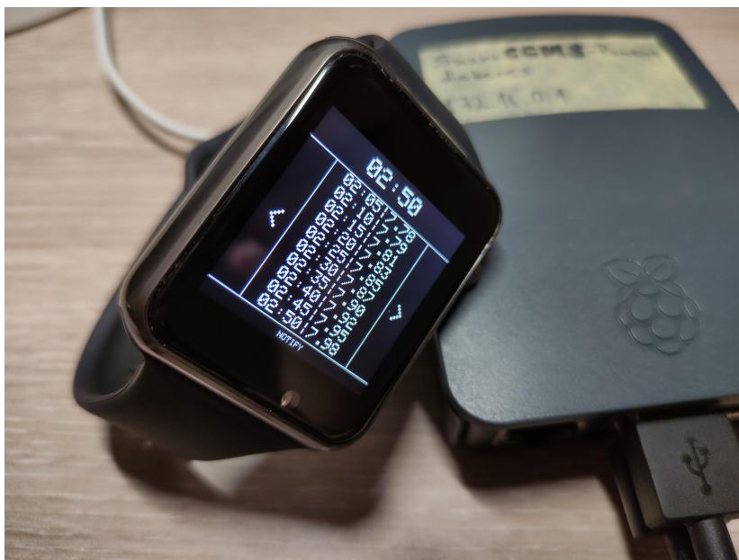
Obrázek 7.6: Řídicí modul zobrazující data naměřená CGM senzorem
