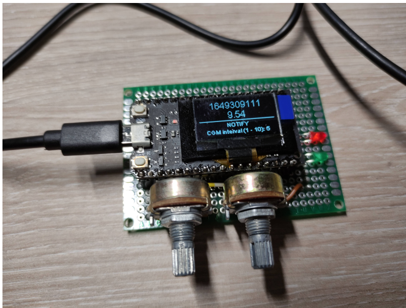
Obrázek 7.2: Zařízení simulovaného CGM senzoru v průběhu simulace
