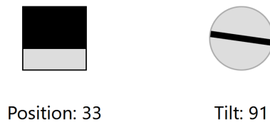
OBRÁZEK 6.4: Příklad vizualizace výstupu regresoru v úloze automatického ovládání žaluzie na základě 15 příznaků.
