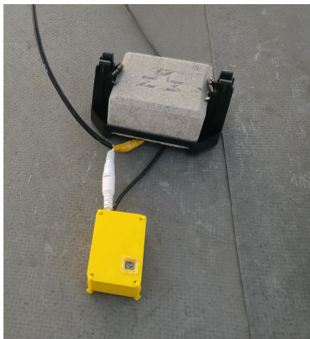
OBRÁZEK 3.1: Skutečné umístění měřicího zařízení na střeše rodinného domu.
