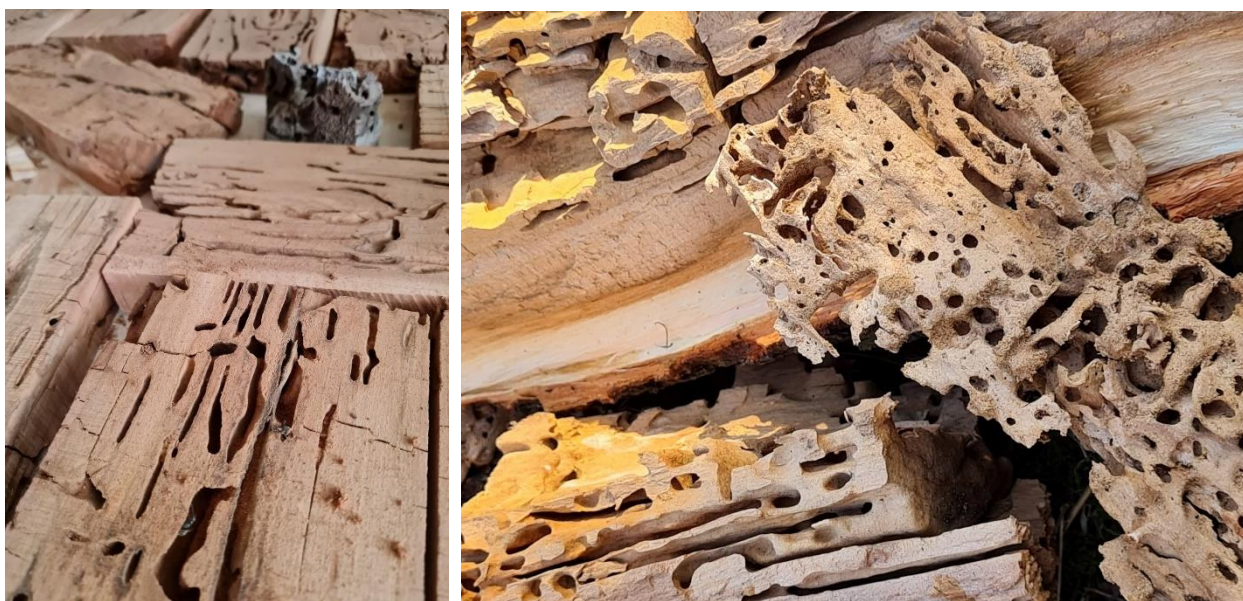
Obrázek č.11,12 – Dřevo napadené houbou a mravenci
