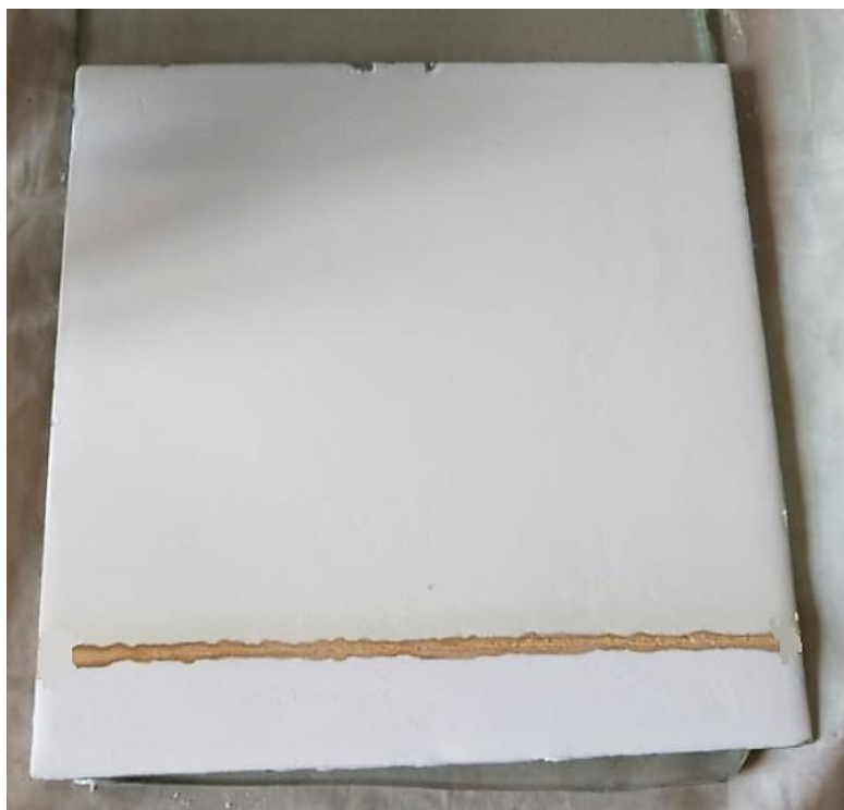
Obrázek 19: Chromatografická deska s naneseným vzorkem 25 .
