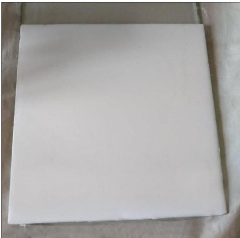
Obrázek 16: Chromatografická deska (20x20cm) pokrytá zaschlým silikagelem 25 .
