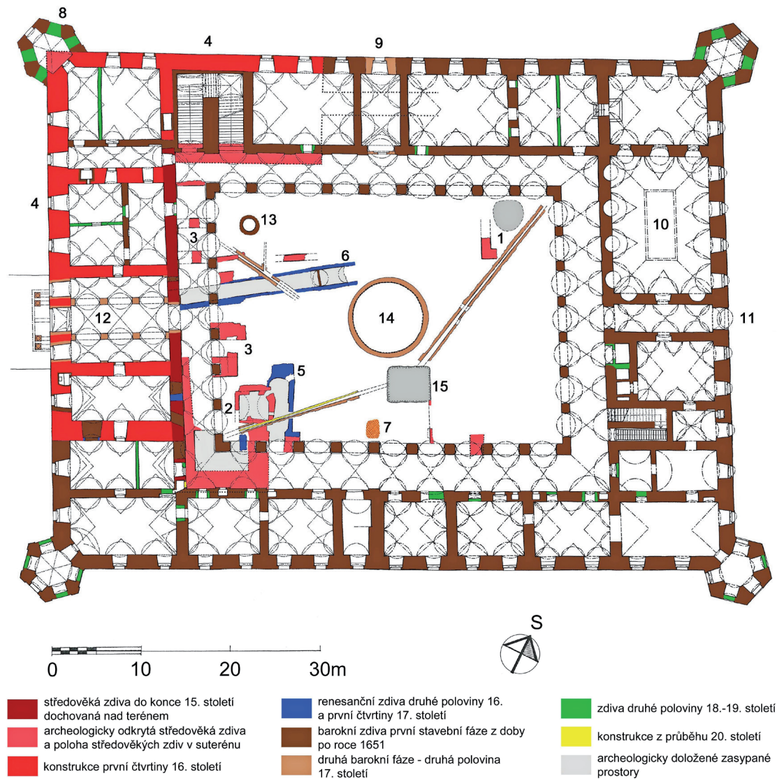
Obr. 6. Holešov zámek. Půdorys přízemí s vyhodnocením stavebního vývoje. 1 – prostor s nálezy středověké keramiky 14. a 15. století; 2 – zasypané klenuté prostory v palácové stavbě, vzniklé zřejmě v průběhu 15. století; 3 – odkryté příčné zdi, které pravděpodobně dělily někdejší interiér palácové stavby z průběhu 15. století; 4 – palác patrně z doby kolem roku 1500; 5 – renesanční přístavba obsahující chodbu a patrně točité schodiště; 6 – klenutá chodba pod nádvořím zřejmě propojující suterény palácových křídel; 7 – kumulace cihlové suti, snad z cihlové vnitřní zdi předpokládaného jižního křídla; 8 – severozápadní, v jádru renesanční nárožní věžice; 9 – poloha raně barokního průjezdu severním křídlem z doby po roce 1651; 10 – prostor nepodsklepené sala terrena; 11 – průjezd do zámecké zahrady; 12 – vstupní hala, zbudovaná po ukončení funkce vstupu v severním křídle (před rokem 1676); 13 – zámecká studna; 14 – barokní vodní nádrž uprostřed nádvoří; 15 – poloha technologického výkopu z roku 2009. Kresba Jan Štětina, 2015, grafická spolupráce Miroslav Lanc, 2015. – Abb. 6. Holešov (Bezirk Kroměříž), Schloss. Grundriss des Erdgeschosses mit Auswertung seiner baulichen Entwicklung. 1 – Bereich, in dem mittelalterliche Keramik aus dem 14. und 15. Jahrhundert gefunden wurde; 2 – zugeschüttete, überwölbte, offenbar während des 15. Jahrhunderts entstandene Räume im Palastgebäude; 3 – freigelegte Querwände, die wahrscheinlich das einstige Interieur des Palastgebäudes aus dem 15. Jahrhundert teilten; 4 – Palast, wahrscheinlich aus der Zeit um 1500; 5 – Anbau aus der Renaissance mit Flur und offenbar auch mit Wendeltreppe; 6 – überwölbter Gang unter dem Hof, der wahrscheinlich die Untergeschosse der Palastflügel verband; 7 – Anhäufung von Ziegelschutt, eventuell aus der inneren Ziegelmauer des mutmaßlichen Südflügels; 8 – nordwestliches Ecktürmchen mit Kern aus der Renaissance; 9 – Lage der frühbarocken Durchfahrt durch den Nordflügel aus der Zeit nach 1651; 10 – Bereich der nicht unterkellerten Sala terrena; 11 – Durchfahrt in den Schlossgarten; 12 – Eingangshalle, erbaut nachdem der Eingang im Nordflügel nicht mehr als solcher diente (vor 1676); 13 – Schlossbrunnen; 14 – barockes Wasserbecken in der Hofmitte; 15 – Stelle einer technologischen Grabung aus dem Jahr 2009. Zeichnung Jan Štětina, 2015, graphische Bearbeitung Miroslav Lanc, 2015.
