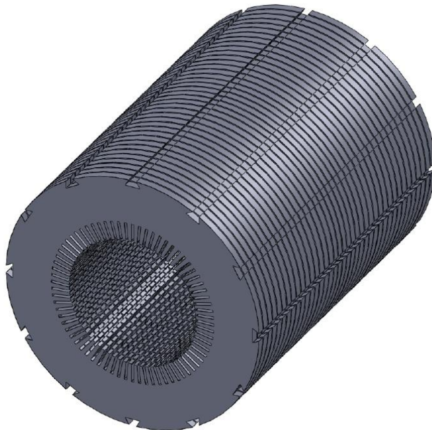
Obr. 2.2: Plechový svazek induktu rozdělený na pakety
