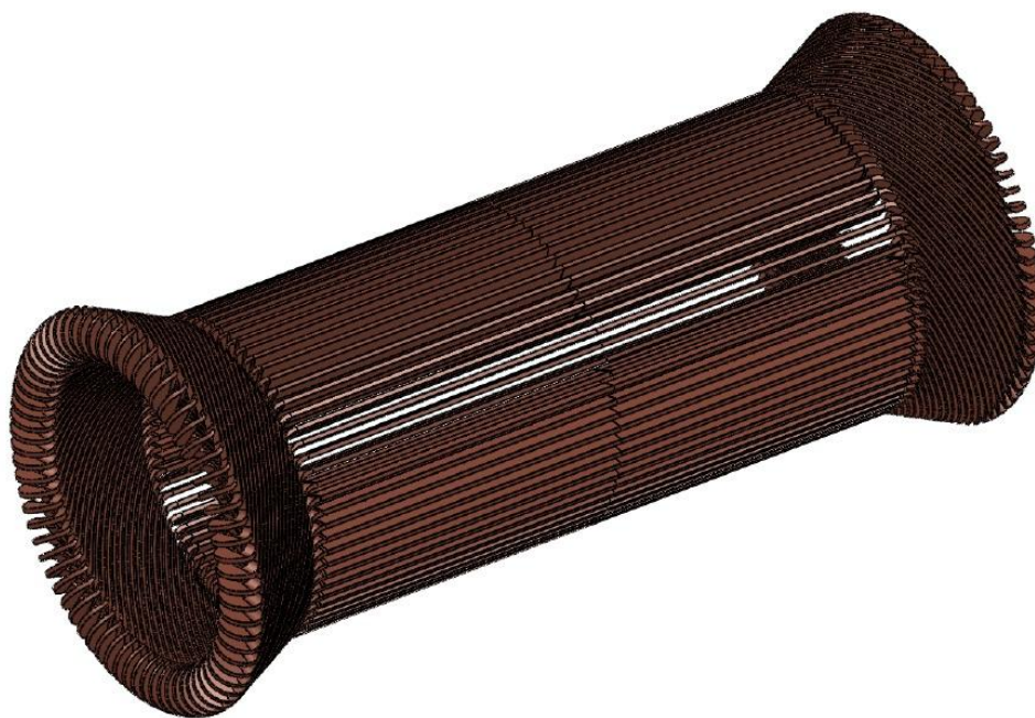
Obr. 2.4: Kuželové vinutí induktu
