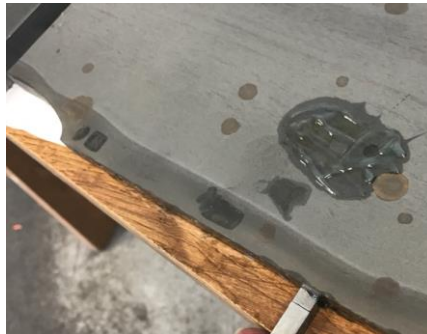
Obr. 9: Vzorek se zakalením podpovrchové vrstvy pro měření ultrazvukem
