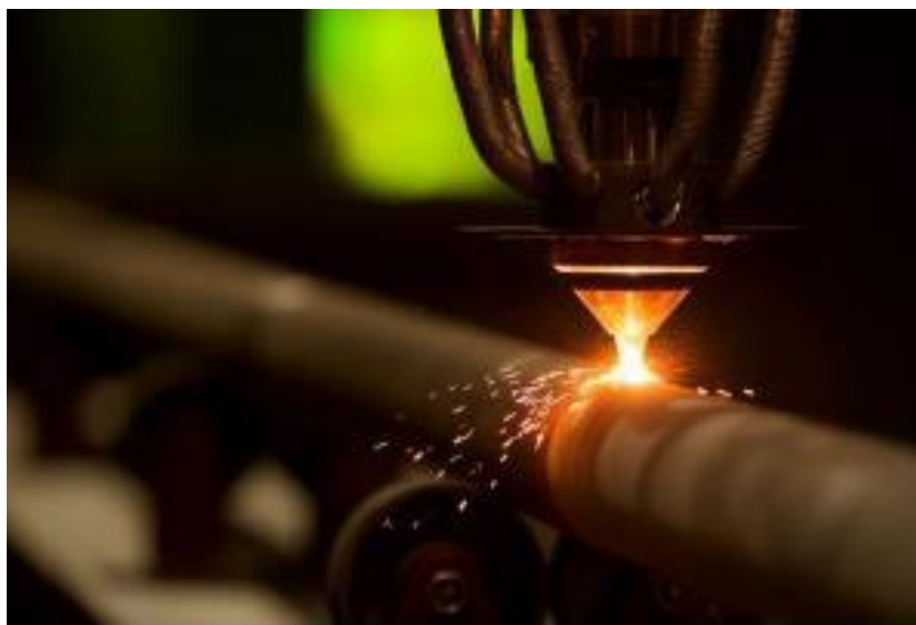
Obr. 9: Navařování trubky laserem (Inconel 625)
