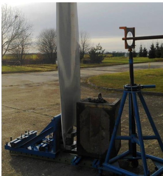
Obr. 2: Realizace zkoušky impakt betonovým tělesem
