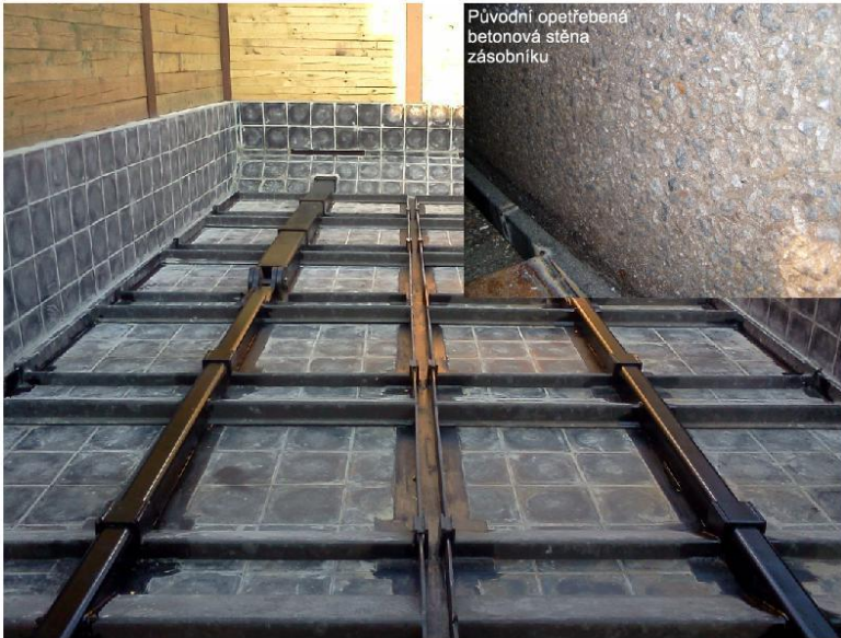
Ukázky otěruvzdorných dílů z čediče a Eucoru
