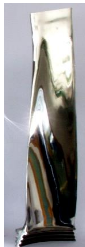
Obr. 5: EJE původní oběžná lopatka posledního stupně
