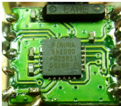
Obr. 4.1: Osazený modul čipem AR1000 firmy AIROHA na destičku 10x10 mm. SMD prvky v okolí mají velikost 0603. V horní části je vidět krystal.
