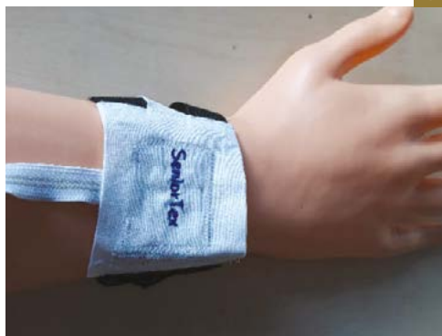
Textilní sensor pro monitorování stavu bariéry pokožky upevněný na zápěstí ruky
