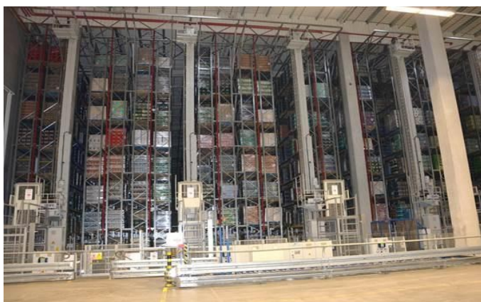
Obr. 15: Automatizované paletové regály s pohledem na kolejnice se zakladačem
