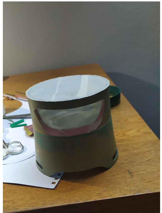
Obr.50 Zakrývání otvorů maskovací páskou před finálním stříkáním konečné barvy.
