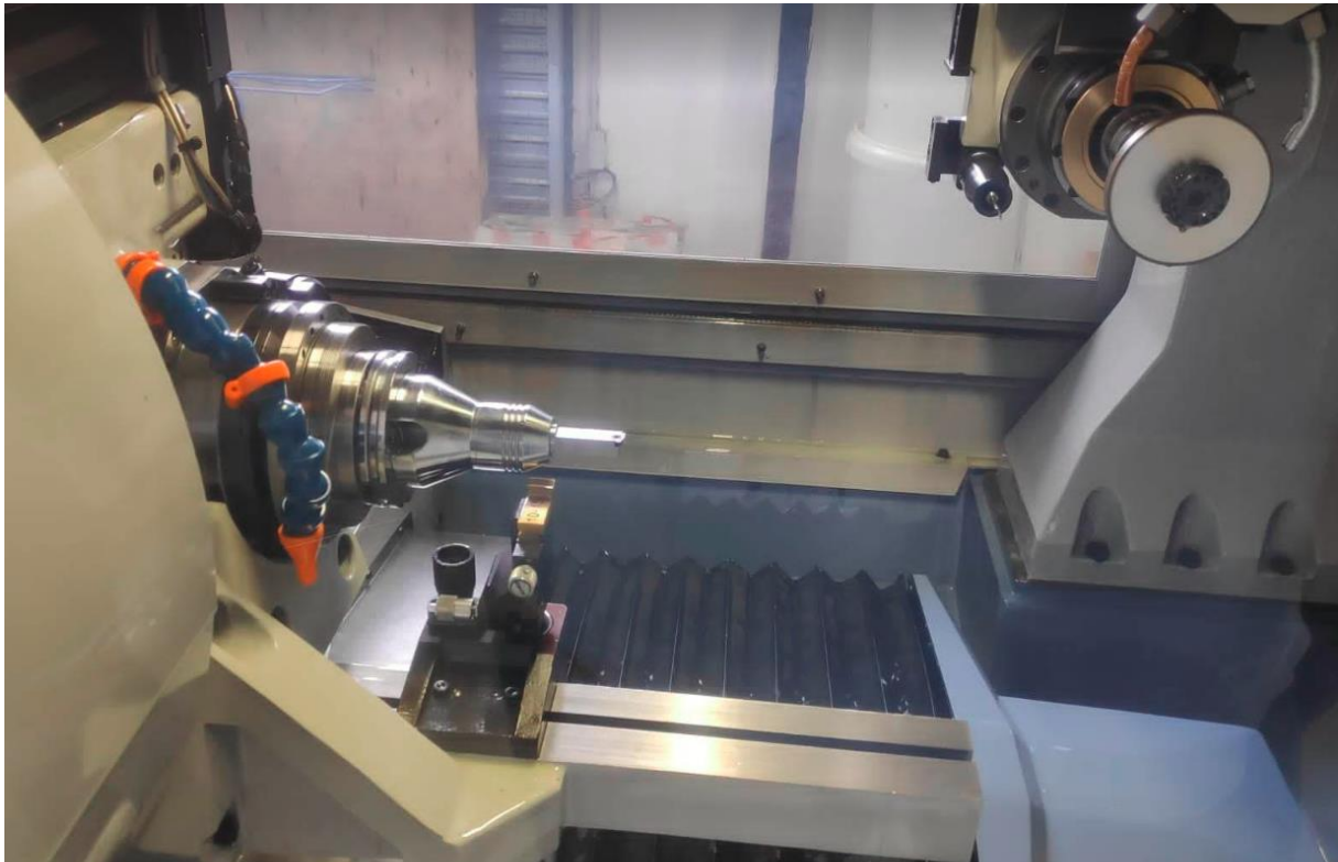
Obrázek 32 – Upnutí držáku ve stroji ANCA MX7
