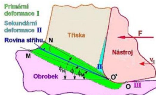
Obrázek 1 - Tvorba plastických deformací v místě obrábění [16]
