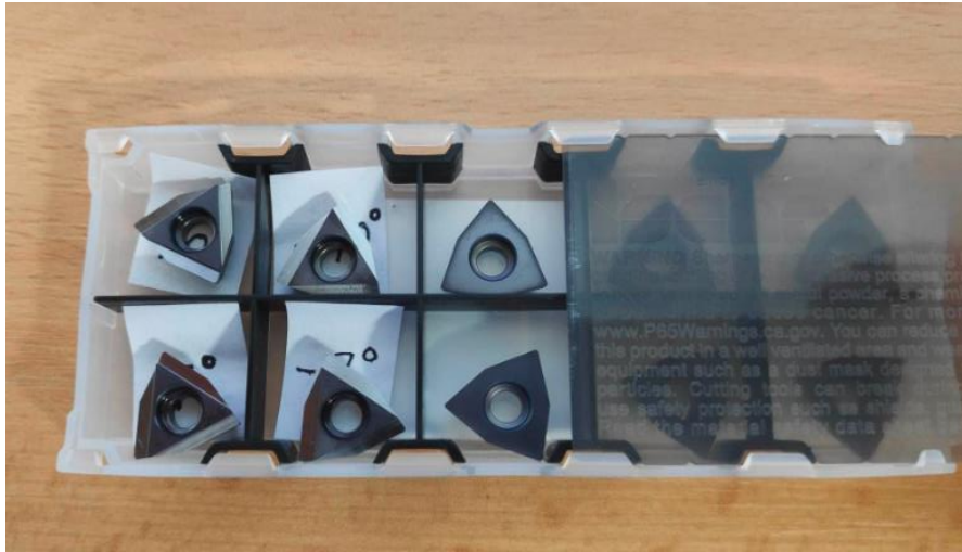
Obrázek 36 – Nabroušené břitové destičky
