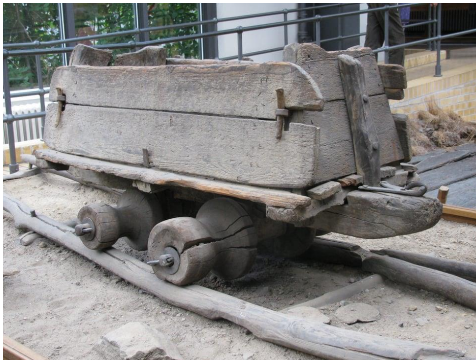
Obrázek 1 - Dřevěné koleje s vozem ze 16. století [2]
