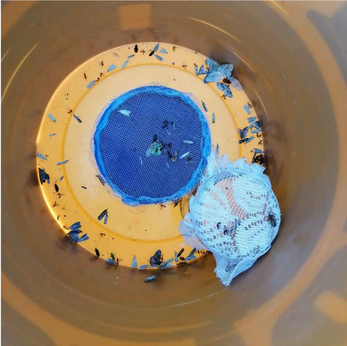
Obr. H. Vnitřní prostor lapače s odtokovým trychtýřem a nádobkou s chloroformem. Foto: J. Vavřínková.
