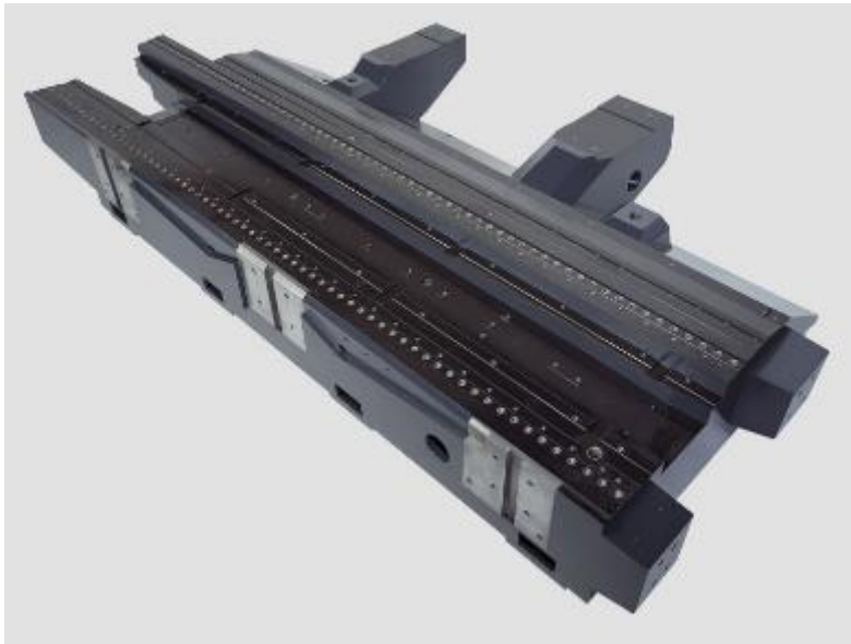
Obr. 3 Odlitek polymer-betonového lože [13]
