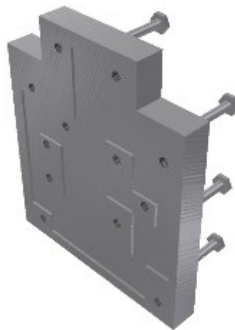
Obr. 18 Čelní deska pro polymer-betonový odlitek
