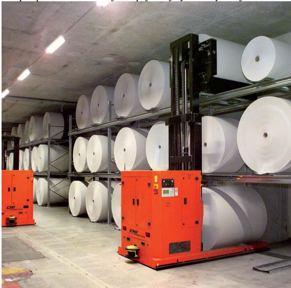
Obrázek 1: AGV se specializovanými vidlicemi [1]
