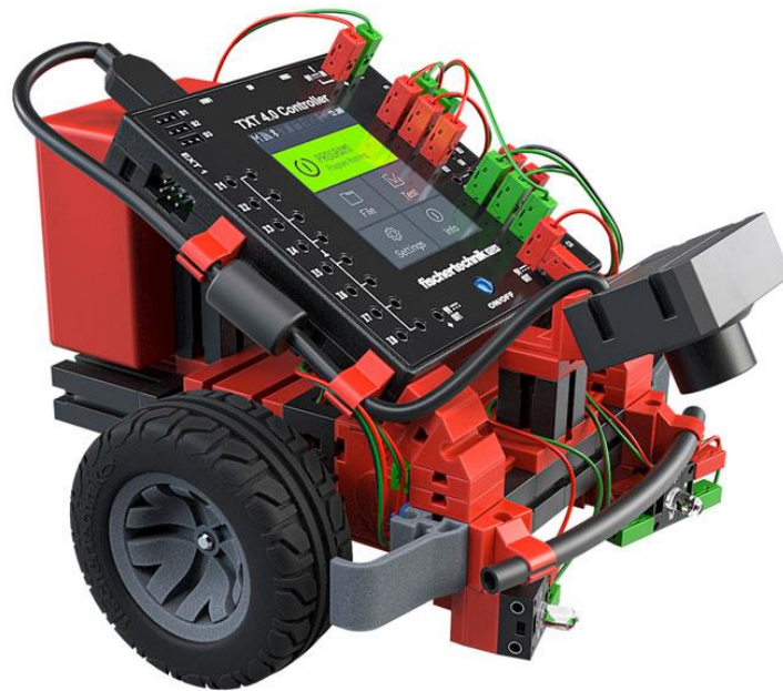
Obrázek 24: Robot s USB kamerou [18]
