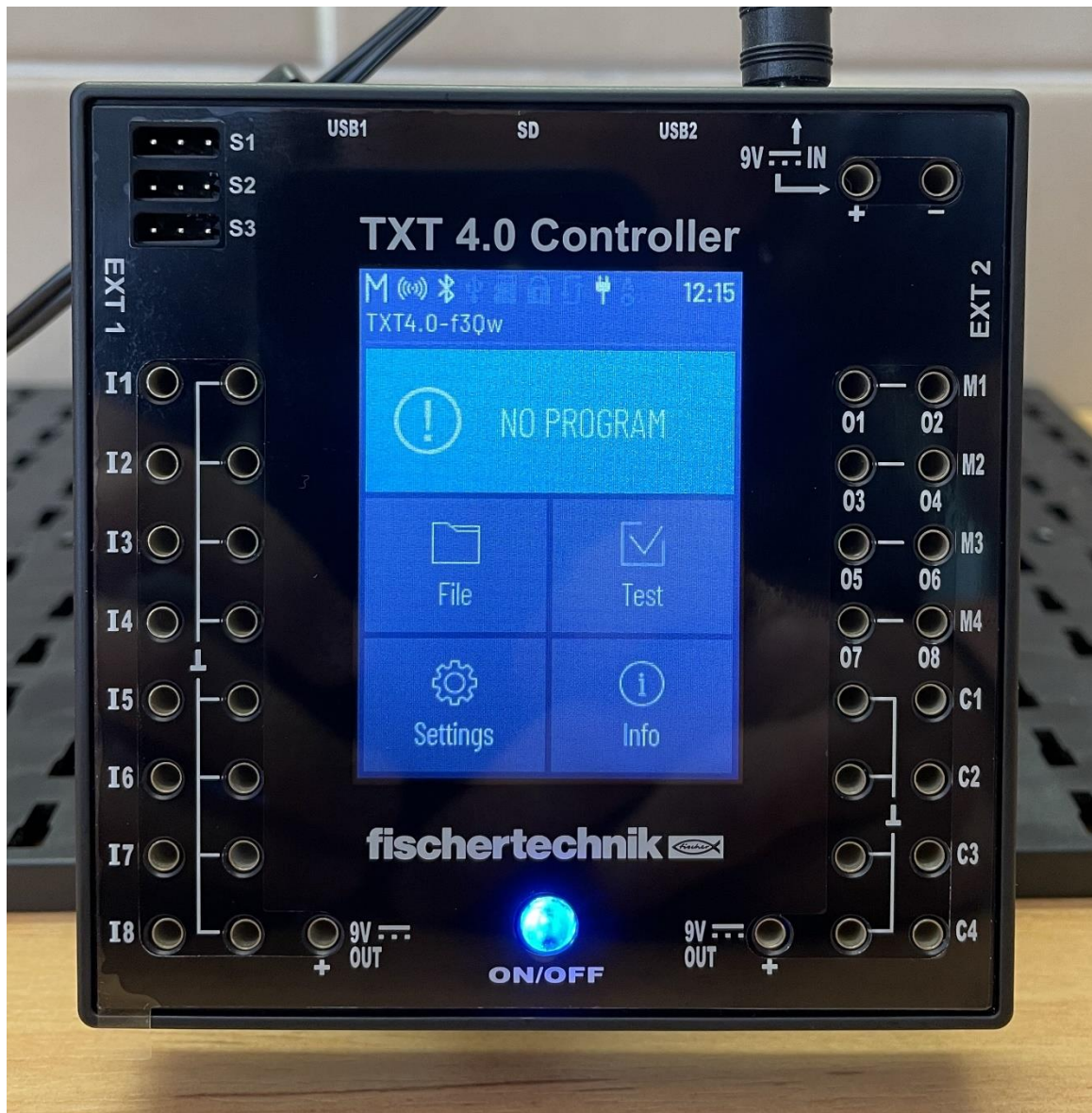
Obrázek 11: Řídící jednotka TXT 4.0 Controller
