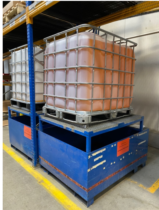
Obrázek 6-2 Zásobovací nádrže s teplovodícím médiem
