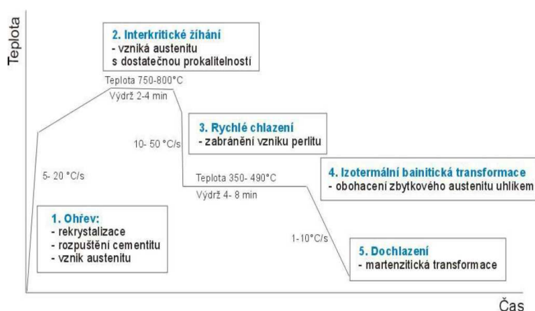
Obrázek 15 Schéma tepelného zpracování TRIP ocelí vyráběných za tepla [21]
