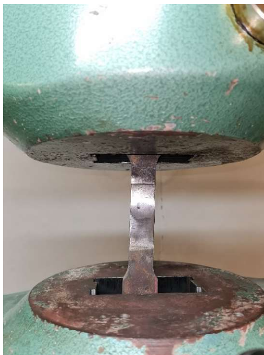
Obr. 15 - Upnutí zkušební tyče do čelistí zkušebního stroje
