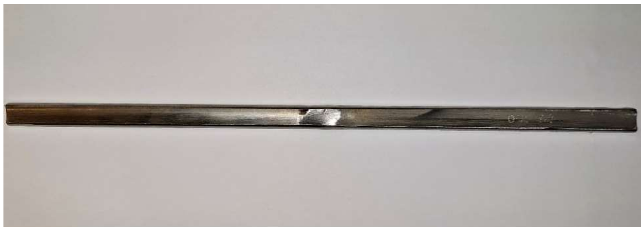
Obr. 33 - Zkušební tyč před zkouškou ohybem
