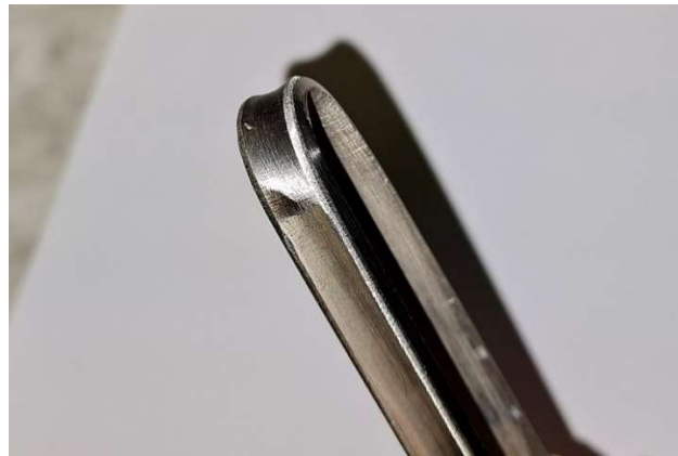
Obr. 46 - Detail zkušební tyče po zkoušce ohybem
