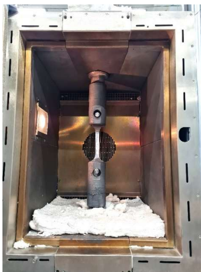
Obr. 30 - Upnutí zkušební tyče při zkoušce tahem za zvýšené teploty do tahového stroje
