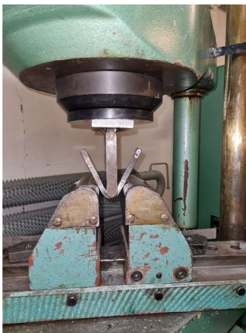
Obr. 42 - Uložení zkušební tyče ve stroji pod zatížením – 2
