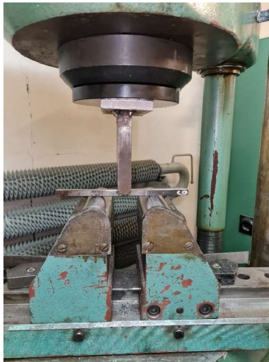
Obr. 40 - Uložení zkušební tyče do stroje před zatížením
