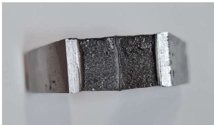
Obr. 60 - Křehký lom na zkušební tyči po zkoušce rázem v ohybu
