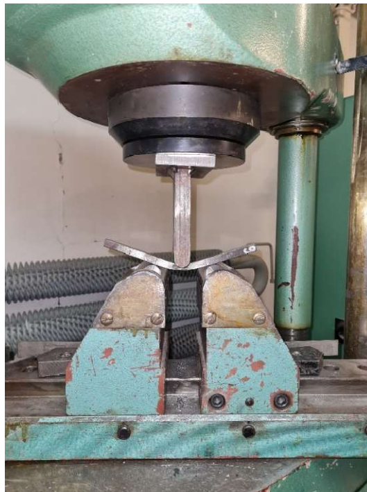
Obr. 41 - Uložení zkušební tyče ve stroji pod zatížením – 1
