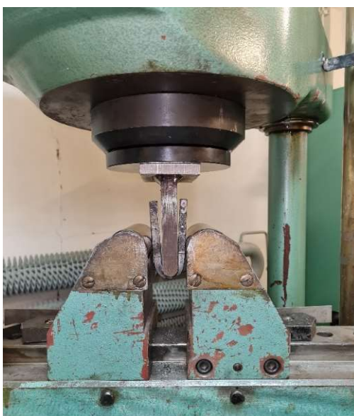
Obr. 43 - Uložení zkušební tyče ve stroji na konci zkoušky ohybem
