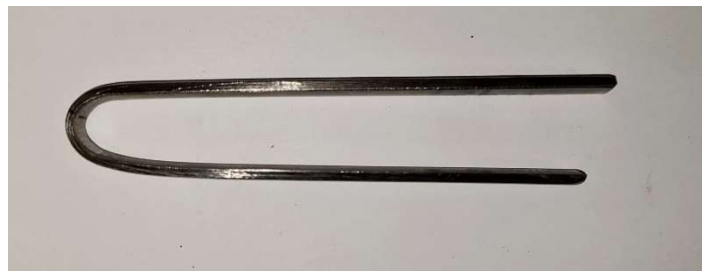
Obr. 45 – Zkušební tyč po zkoušce ohybem
