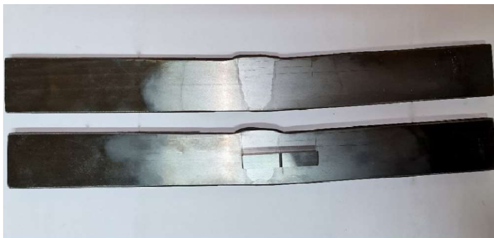
Obr. 64 – Zkušební tyč s vrubem v tepelně ovlivněné oblasti
