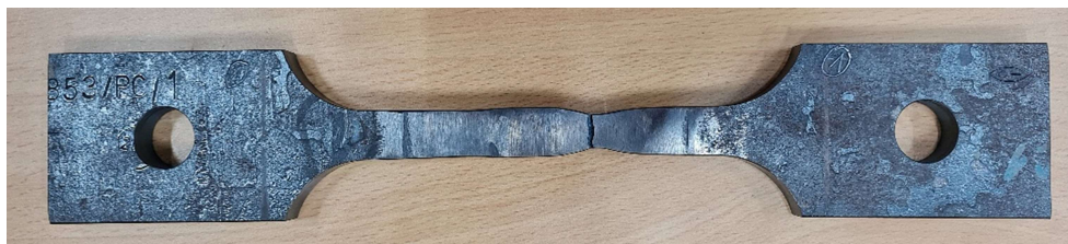
Obr. 29 - Zkušební tyč pro zkoušku tahem za zvýšené teploty – po zkoušce
