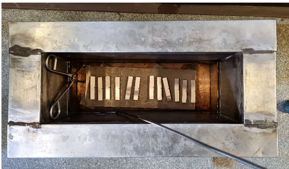
Obr. 61 - Chladící se zkušební tyče na teplotu -20\text{ }^{\circ}\text{C}
