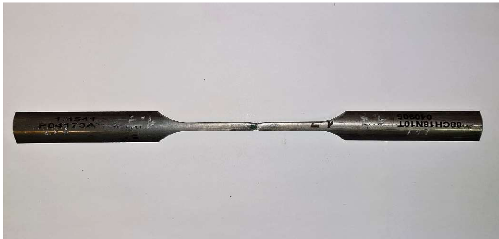
Obr. 23 - Tyč pro příčnou zkoušku tahem (po zkoušce)
