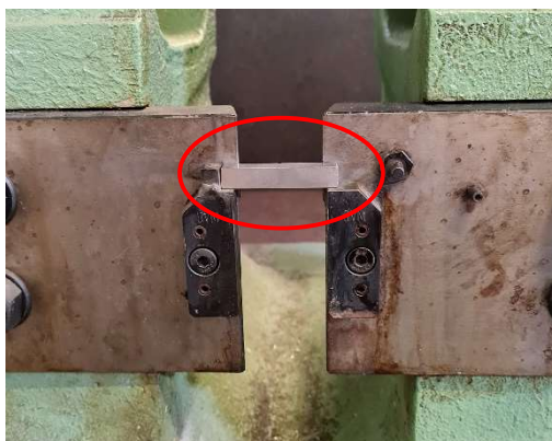
Obr. 63 - Uložení zkušební tyče do stroje pro zkoušku rázem v ohybu
