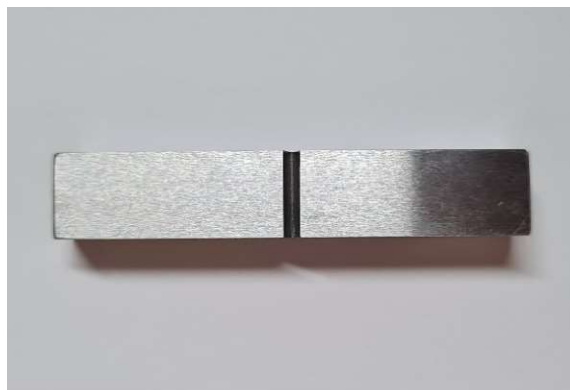
Obr. 57 - Zkušební tyč s vrubem – pohled shora
