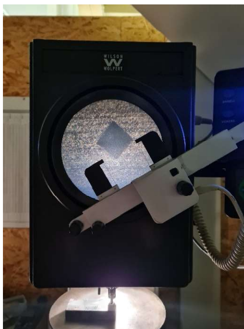
Obr. 66 - Matnice tvrdoměru s vtiskem
