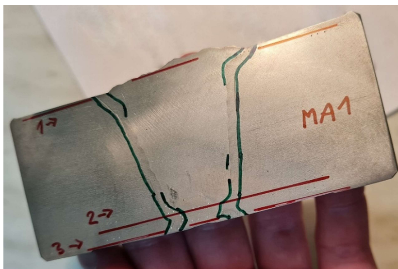
Obr. 74 - Ukázka zkušební tyče po zkoušce tvrdosti, kde jsou patrné vtisky
