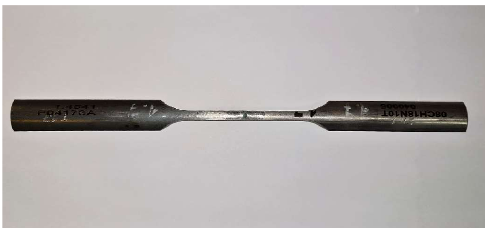
Obr. 19 – Tyč pro příčnou zkoušku tahem (před zkouškou)
