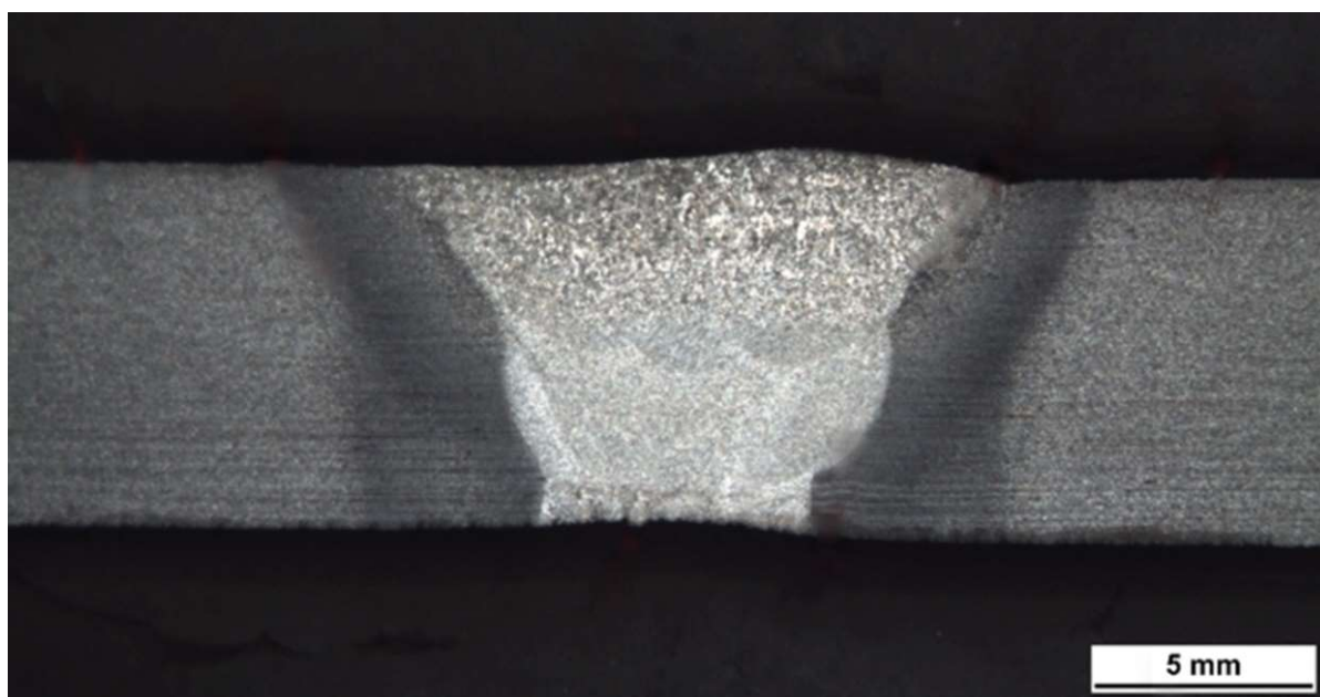
Obr. 76 - Zkušební tyč pro makroskopickou kontrolu [36]
