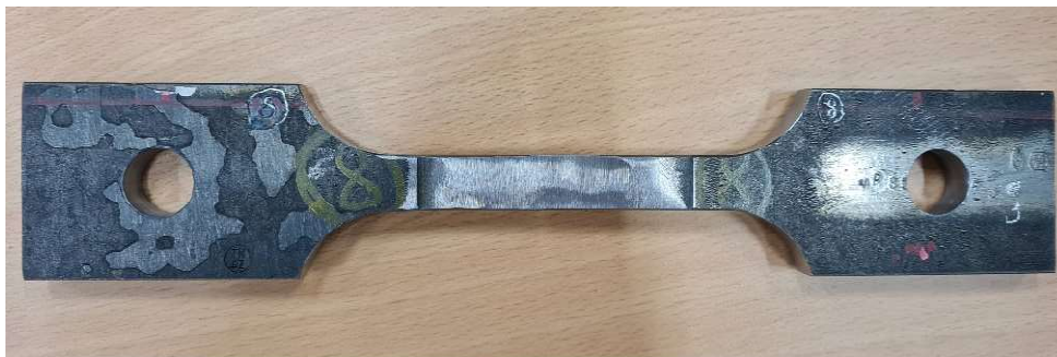
Obr. 28 – Zkušební tyč pro zkoušku tahem za zvýšené teploty – před zkouškou
