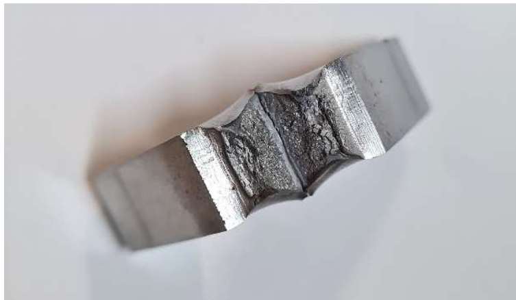
Obr. 59 - Tvárný lom na zkušební tyči po zkoušce rázem v ohybu
