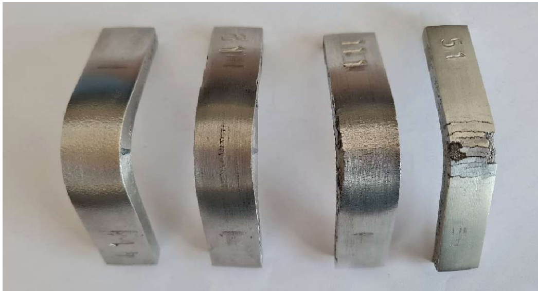
Obr. 82 - Viditelnost mezikystalové koroze pouhým okem
