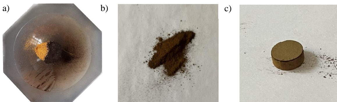
Obr. 11 a) Poměr prášků SiO 2 a V 2 O 5 (1/4), b) barva směsného prášku, c) připravená směsná peleta (terč) k pulsní laserové depozici
