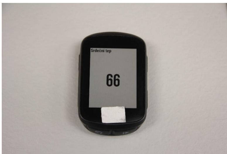
Obrázek 7 Bezkontaktní zařízení pro sledování hodnoty srdeční frekvence z hrudního pásu
