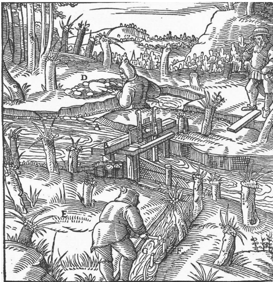
Řeka A. Jez B. Stavidla C. Výkop D. Lučina E. Plot F. Příkop G.
