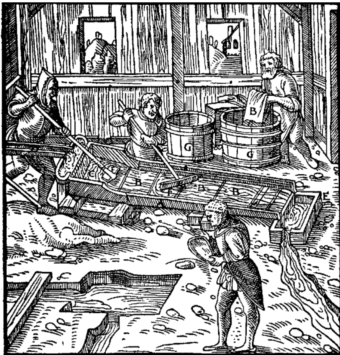
Prkna A. Plachty B. Hlava splavu C. Žlábek D. Necky E. Dřevěné snímačky F. Sudy G.
