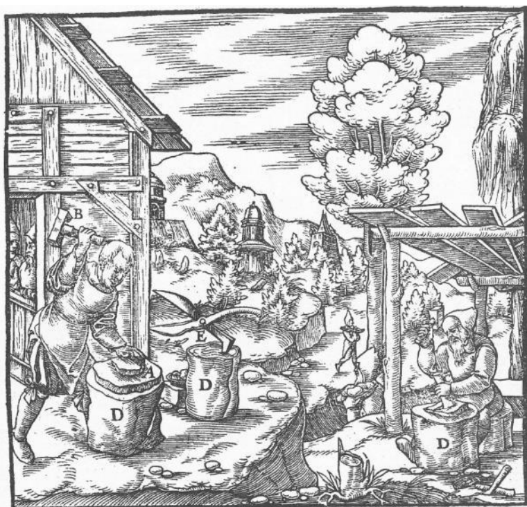
Kus rudy A. Kladivo B. Klín C. Špalek D. Železný nástroj podobný nůžkám E.
