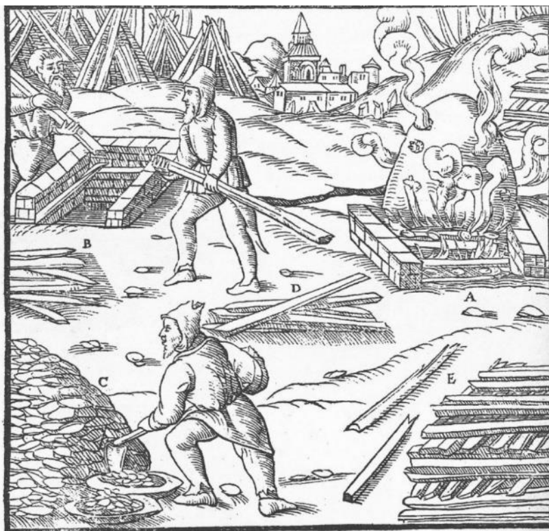
Zapálené pražiště A. Pražiště, které se připravuje B. Ruda C. Děva D. Hranice dřev E.
