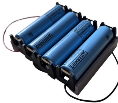
Obrázek 16: Ukázka použitých Li-On článků v připevněných pouzdrech
