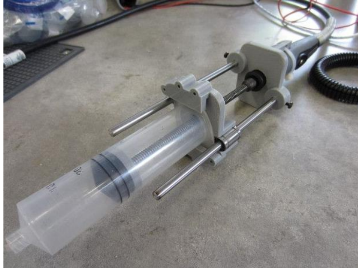
Obr. 15: Příklad mechanického řešení extruderu [23].
