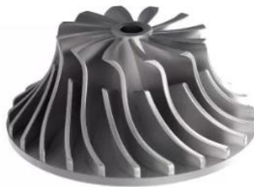
Obr. 2: Ukázka vytisknuté struktury kovového výrobku [4].
