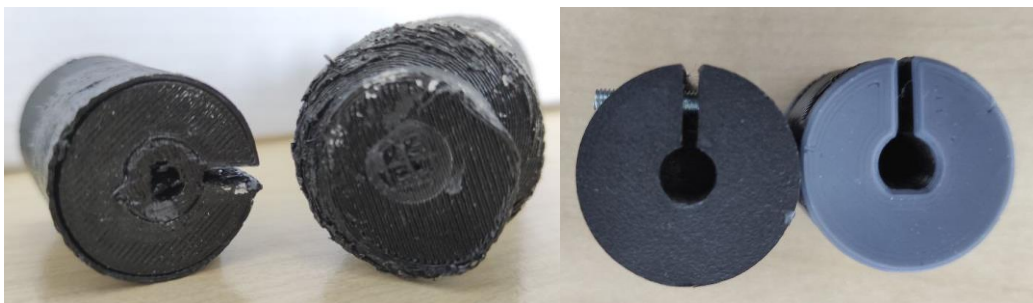
Obr. 36: Ukázka nedostatků spojení spojky a šnekovnice.
