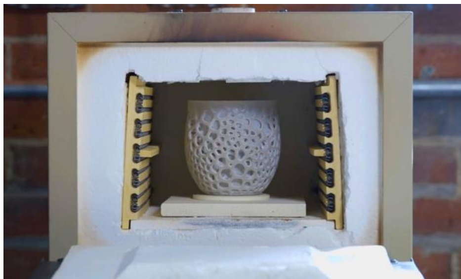
Obr. 9: Vypalování výtisku z keramického resinu Formlabs [12].
