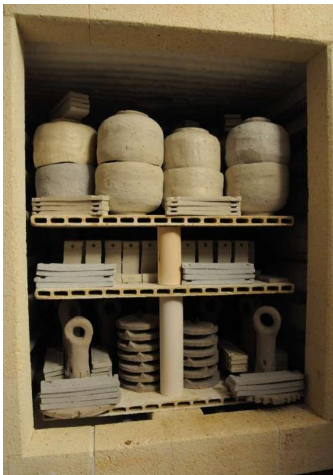
Obr. 4 Keramické výrobky v peci před výpalem [11].
