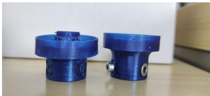
Obr. 25: Deformovaný domek (vlevo) oproti nedeformovanému (vpravo).
