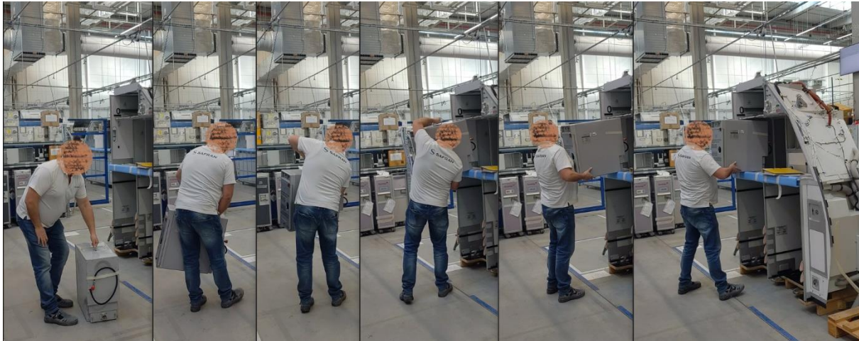
Obr. 4.8-2 Proces zdvíhání a zakládání spotřebiče do monumetu
