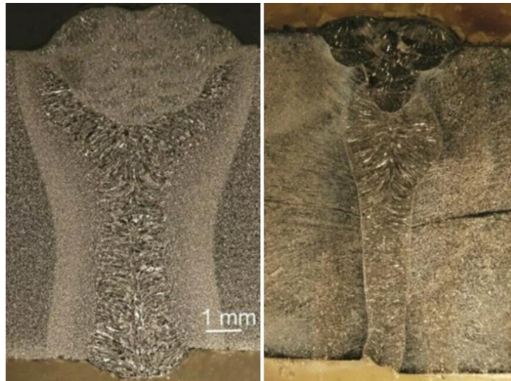
Obrázek 15: Příčné řezy svary plechu 10 mm na oceli S355 (vlevo) a korozivzdorné oceli (vpravo) s viditelným doplněním drátu do hlavy svaru [2]
