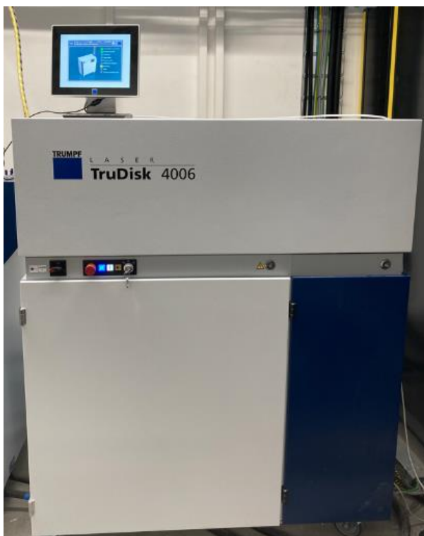
Obrázek 39: Diskový laser TruDisk o výkonu 4 kW od společnosti TRUMF
