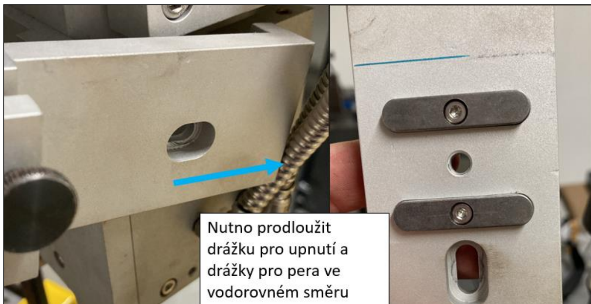
Obrázek 41: Úprava držáku hořáku
