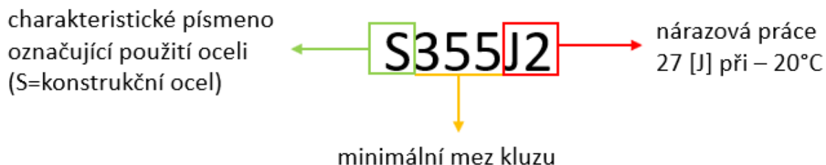
Obrázek 46: Označování ocelí dle ČSN EN 10027-2 [25]
