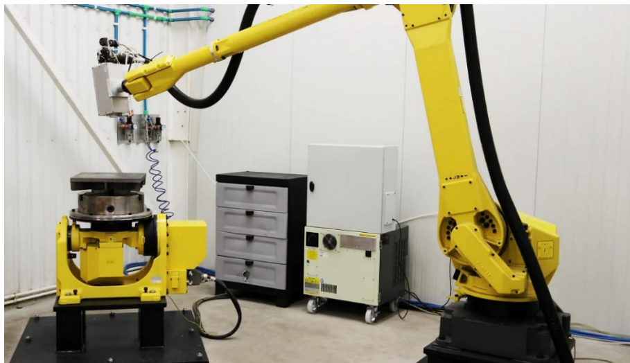
Obr. 15. Technologie pro metodu LMD (robotické rameno s laserovou hlavou a podavačem prášku + otočný stůl + laserový zdroj) [53].
