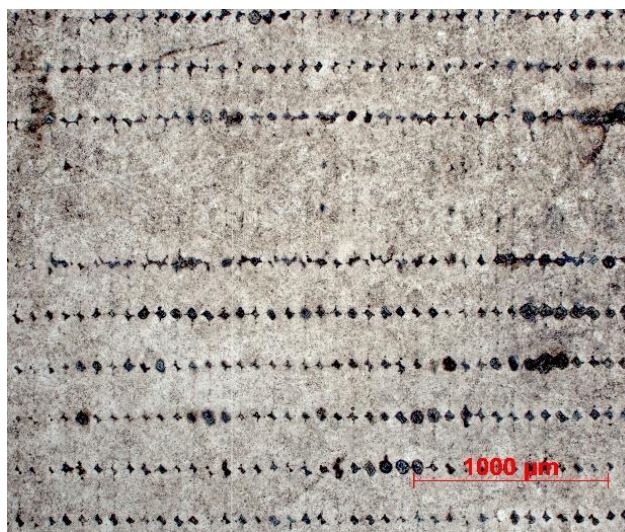
Obr. 52. Mikrostruktura vzorku tištěného horizontálně metodou BMD z oceli H13 po austenitizaci při 1010 °C a trojím popouštění při 585 °C, zvětšeno 100x.
