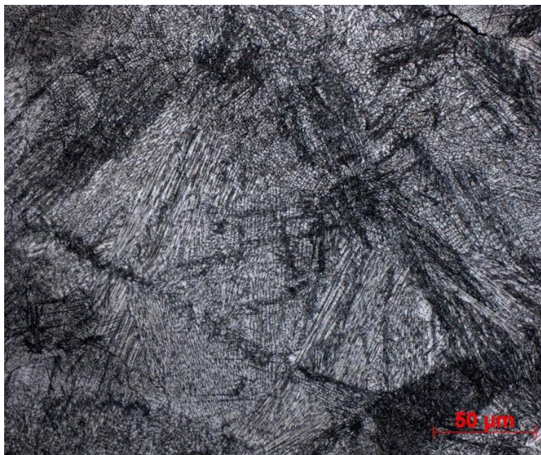
Obr. 9. Snímek mikrostruktury SLM vzorků pomocí optického mikroskopu rovnoběžně na směr stavby (zvětšeno 500x) [10].
