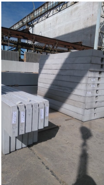
Obr. č. 23: Sklad hotových panelů
