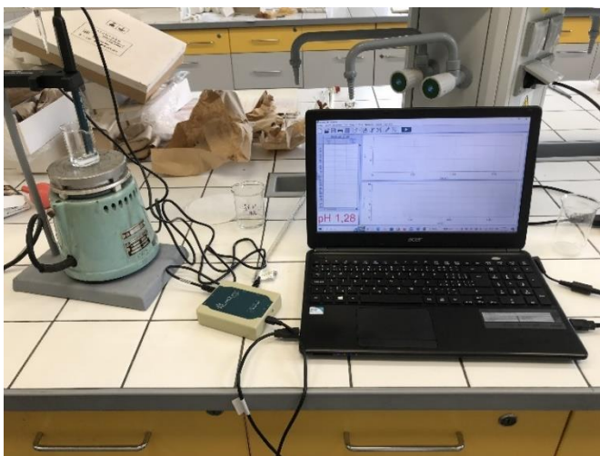
Obr. 24. Titrační aparatura a měřicí systém Vernier
