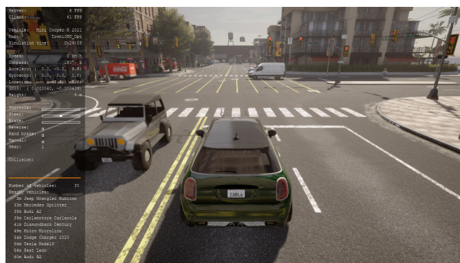
Obrázek 3.3: Ukázka prostředí simulátoru Carla včetně možných pohledů senzorů.
