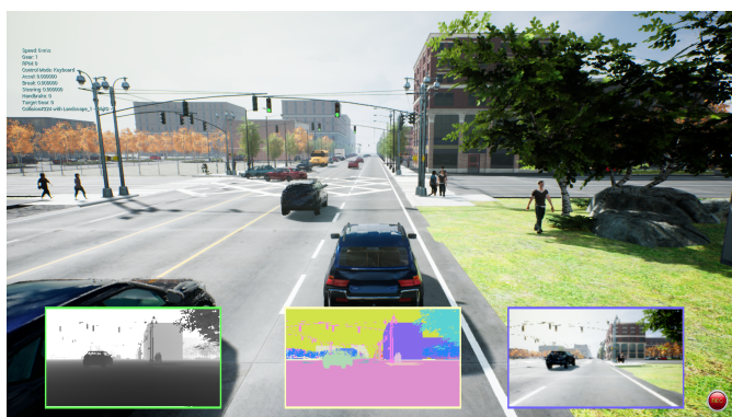
Obrázek 3.2: Ukázka prostředí simulátoru AirSim včetně možných pohledů senzorů.
