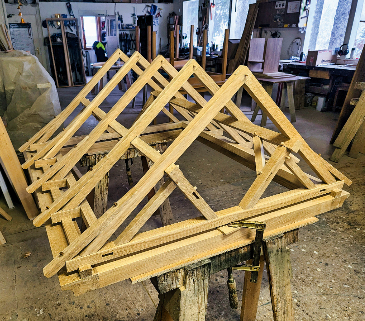
Obrázek 10: Výukový sestavovací model historického krovu podélně vázaného šikmou stolicí (foto Jakub Novotný, ÚTAM AV ČR).
