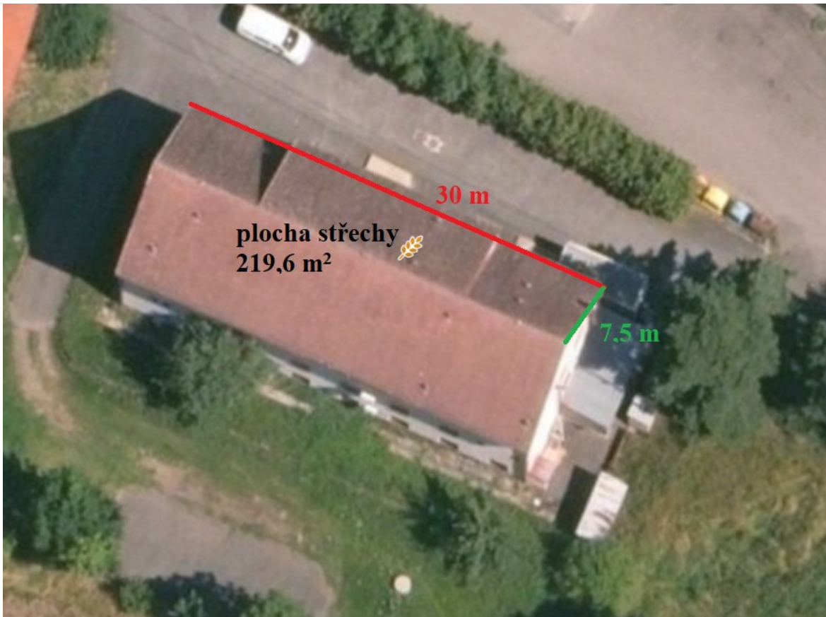
Obr. 5: Okótovaná střecha firmy Biopekárna Zemanka
